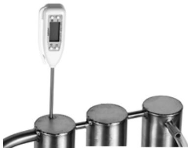
7. À une température de 70 °C sur le thermomètre situé sur le couvercle du récipient, commencez le refroidissement avec un léger courant d'eau circulant dans le réfrigérant, en attendant les premiers condensats.
