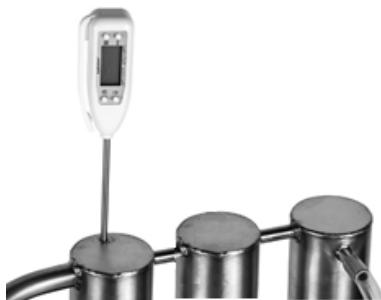
7. Man soll bei der am Temperaturmesser am Behälterdeckel angezeigten Temperatur von 70 °C mit der Kühlung starten, zuerst mit dem langsam fließenden Wasser durch den Kühler und auf das Kondensatwasser warten.
