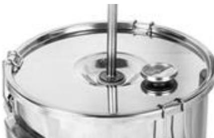
3. Натянуть тефлоновую ленту (не входит в комплект) на резьбу отстойника, накручивая на нее шариковый вентиль. После накручивания убедится что она закрыта.
