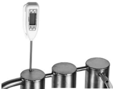
7. Při teplotě 70 °C na teploměru umístěném na víku nádoby začněte s chlazením jemným proudem vody protékajícím přes chladič, počkejte na první kondenzát.
