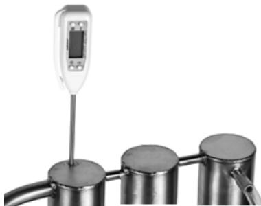
7. Amikor a fedélen levő hőmérő 70 °C-os hőmérsékletet mutat, elkezdeni a hűtést gyengéd vízsugár hűtőelemen való átfolytatásával, megvárva az első lecsapódást.
